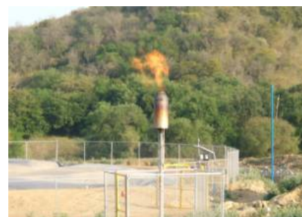
Combustión de biogás través de un quemador, para contabilizar “bonos de carbono”.
